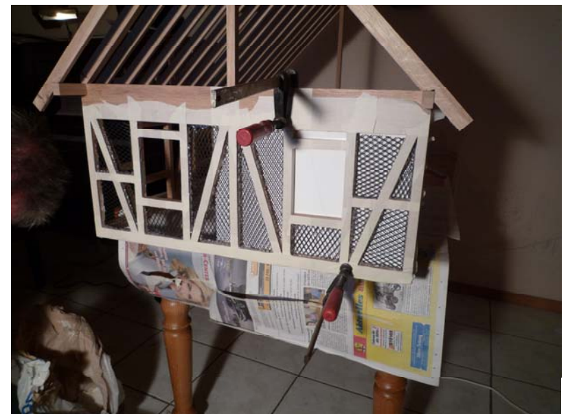
Abbildung 12: Vorbereitung zum verputzen
